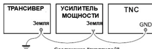
НЕПРАВИЛЬНОЕ ПОДКЛЮЧЕНИЕ ЗАЗЕМЛЕНИЯ
