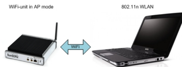
Рисунок 2.1 - Подключение трансивера по беспроводной сети напрямую к ПК
